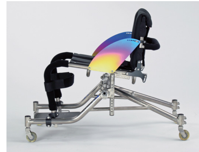
背角度・高さ可変機能 背角度: 座面に90°~72° (3°刻み) で調整可能。 背高さ: 200~350mm (S・M 2種類有り)
